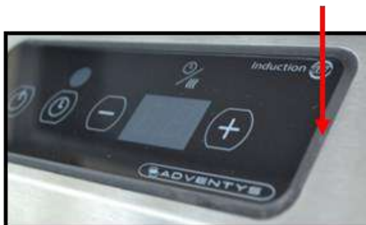
Joint silicone et montage en affleurement
